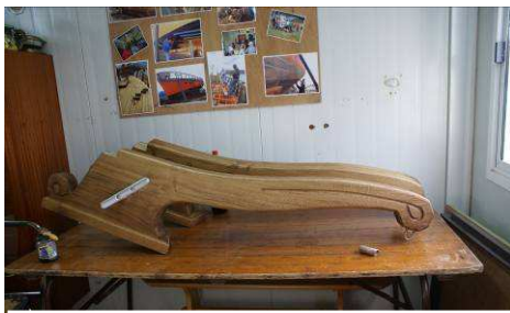
Les bossoirs vernis, sont prêts pour la pose
