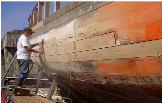
Ponçage mise en forme
